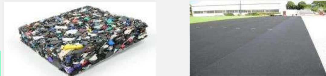
Exemple de Couche de souplesse préfabriquée et coulée en place
