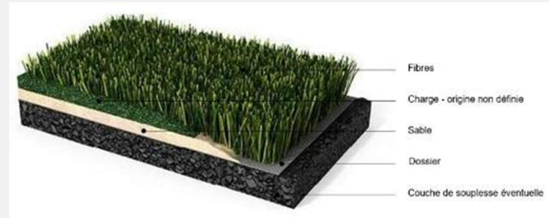
Coupe de principe d'un revêtement en gazon synthétique
